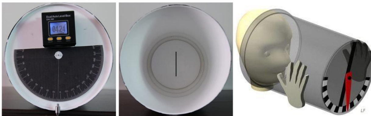
Рисунок 13 – Купол для исследования субъективной зрительной вертикали
