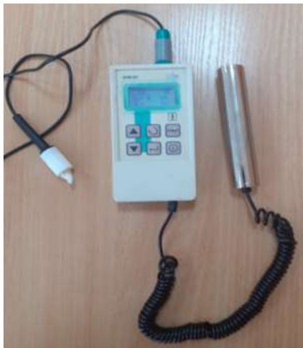
Рисунок 8 - Измеритель электрической проводимости кожи SCM-101
