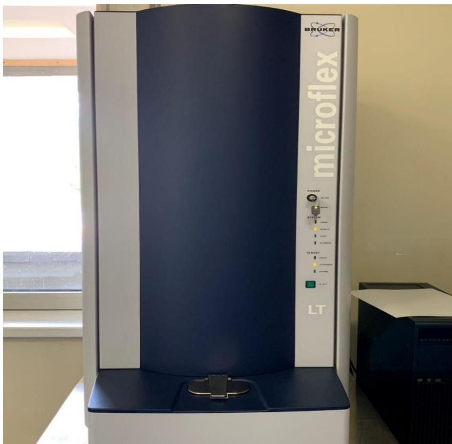
**Рисунок 8.** MALDI масс-спектрометр microflex
